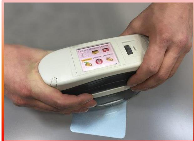
Подключите спектрофотометр к программе и загрузите новое измерение со
